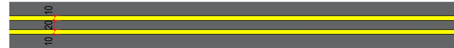
LFO-4 - LINHA CONTÍNUA / SECCIONADA ESCALA 1 : 50
