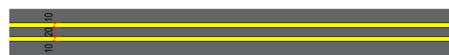
LFO-4 - LINHA CONTÍNUA / SECCIONADA ESCALA 1 : 50
