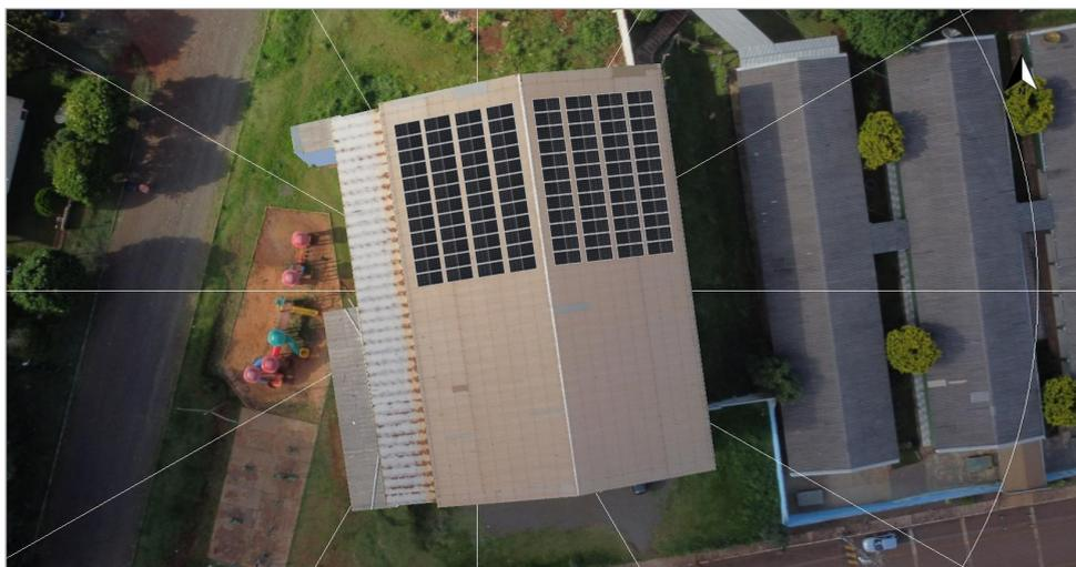
Figura 6 - Distribuição dos módulos no telhado (3). (300m<sup>2</sup>)
