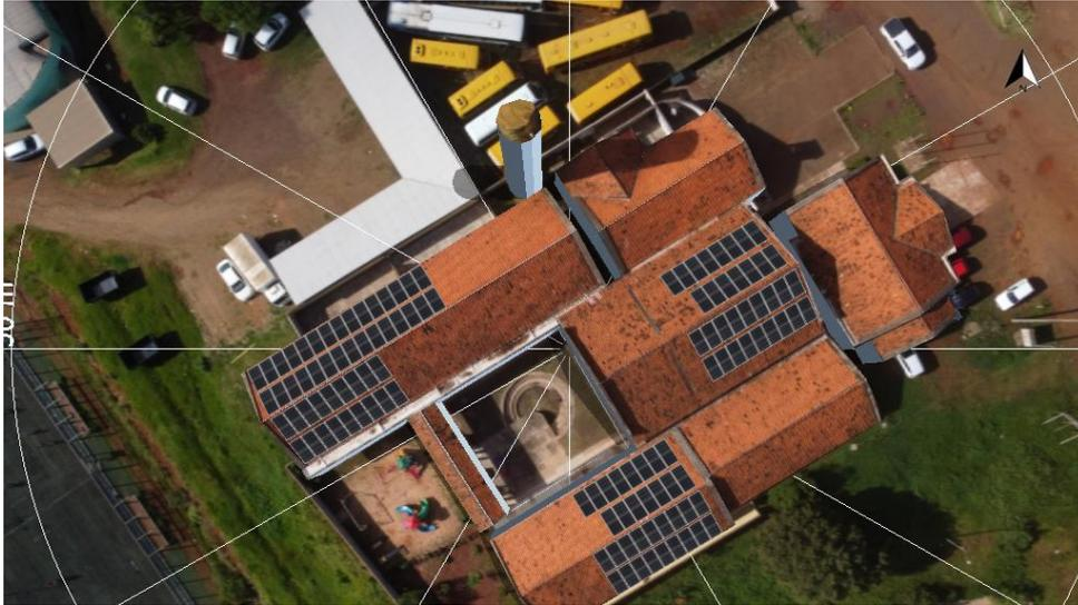
Figura 2 – Distribuição dos módulos no telhado (1).(300 m<sup>2</sup>)
