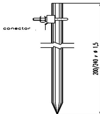
Figura 22 - Padrão do Eletrodo de Aterramento
