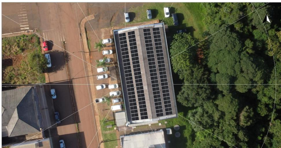
Figura 8 – Distribuição dos módulos no telhado (4). (300 m<sup>2</sup>)
