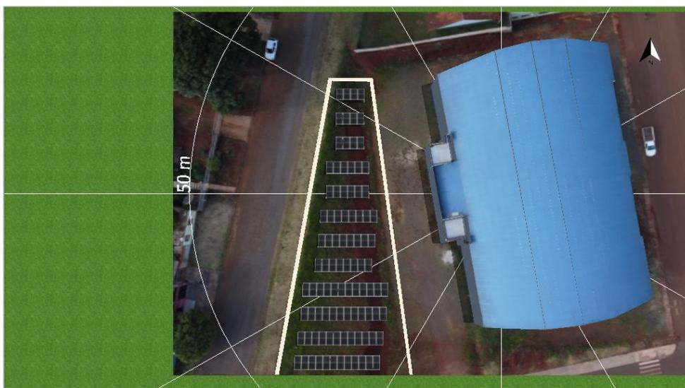
Figura 4 – Distribuição dos módulos no solo (2). (500m<sup>2</sup>)
