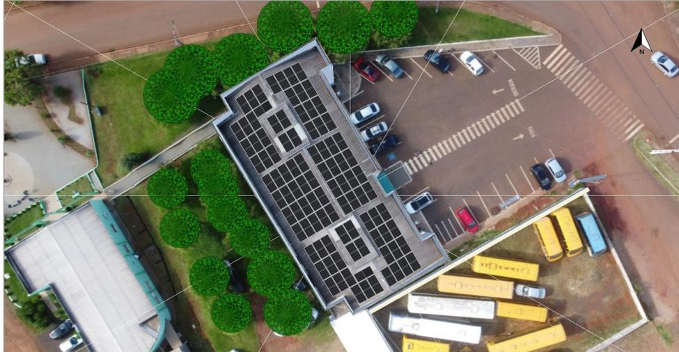
Figura 10 – Distribuição dos módulos no telhado (5). (300m<sup>2</sup>)
