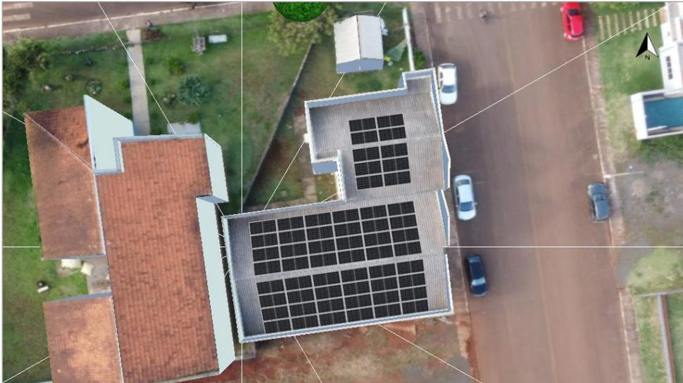
Figura 12 - Distribuição dos módulos no telhado (6). (150m<sup>2</sup>)
