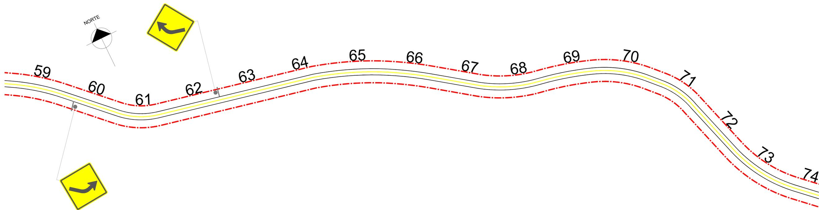
POSICIONAMENTO TRANSVERSAL - VIAS RURAIS SEM ACOSTAMENTO SEM ESCALA
