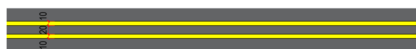
LFO-4 - LINHA CONTÍNUA / SECCIONADA ESCALA 1 : 50
