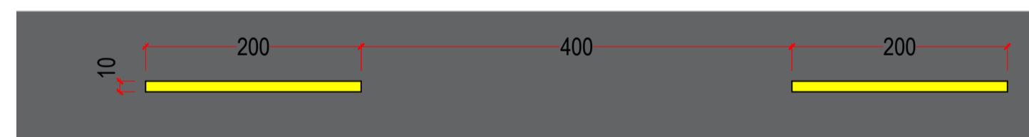
LFO-2 - LINHA SIMPLES SECCIONADA ESCALA 1 : 50
