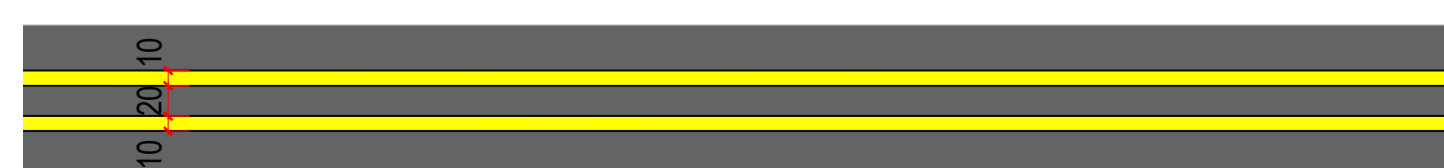
LFO-4 - LINHA CONTÍNUA / SECCIONADA ESCALA 1 : 50
