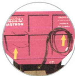
Escada e suporte para mangueiras
