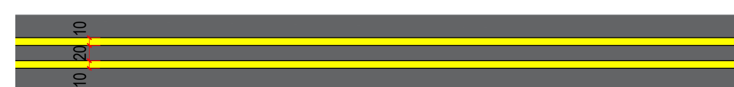
LFO-4 - LINHA CONTÍNUA / SECCIONADA ESCALA 1 : 50
