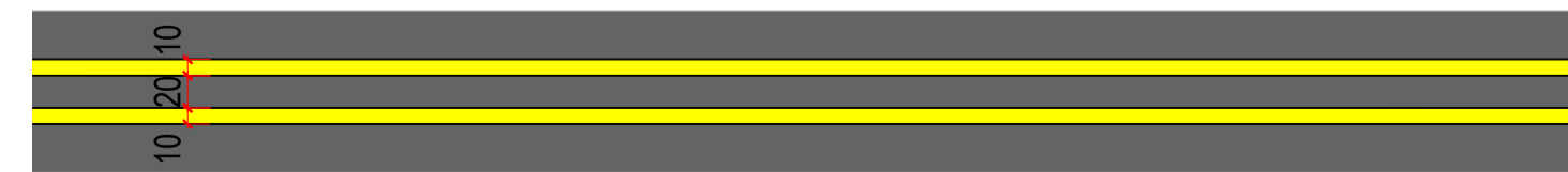
LFO-4 - LINHA CONTÍNUA / SECCIONADA ESCALA 1 : 50
