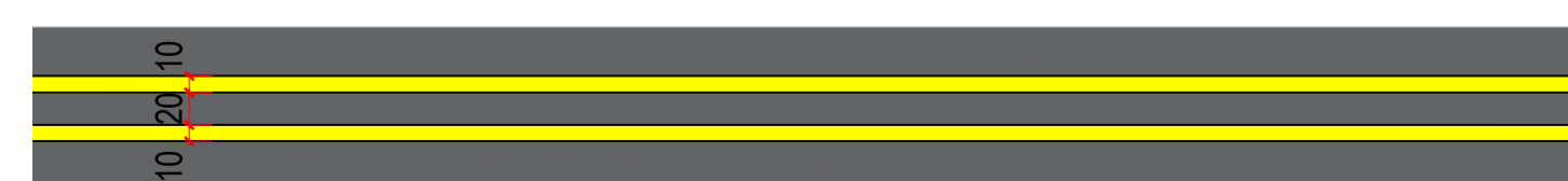
LFO-4 - LINHA CONTÍNUA / SECCIONADA ESCALA 1 : 50
