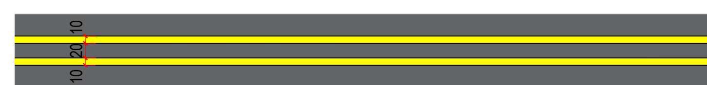
LFO-4 - LINHA CONTÍNUA / SECCIONADA ESCALA 1 : 50
