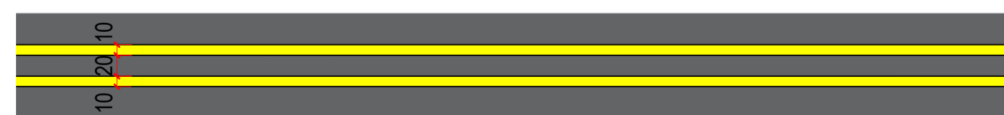
LFO-4 - LINHA CONTÍNUA / SECCIONADA ESCALA 1 : 50
