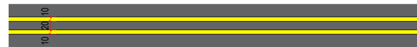
LFO-4 - LINHA CONTÍNUA / SECCIONADA ESCALA 1 : 50
