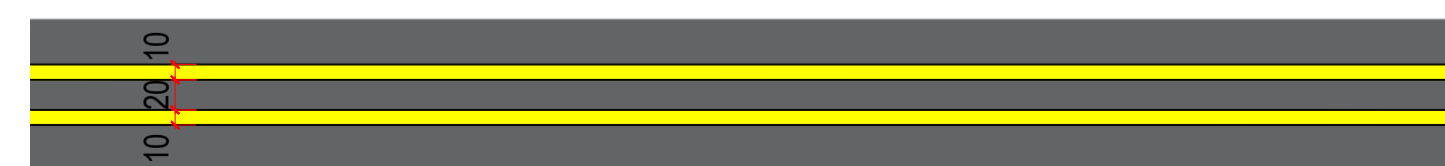
LFO-4 - LINHA CONTÍNUA / SECCIONADA ESCALA 1 : 50
