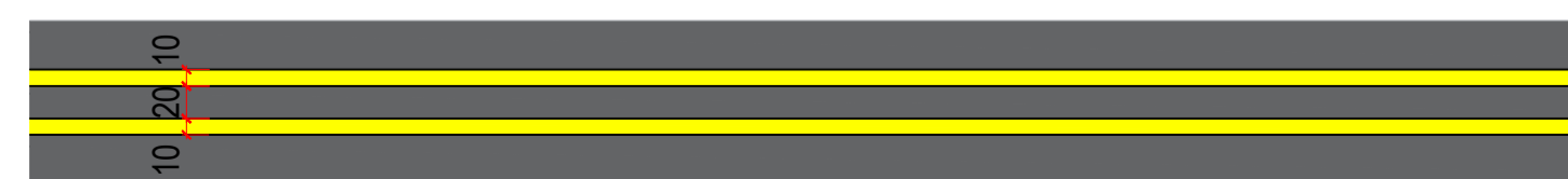
LFO-4 - LINHA CONTÍNUA / SECCIONADA ESCALA 1 : 50
