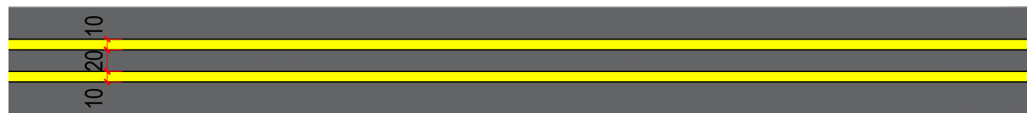
LFO-4 - LINHA CONTÍNUA / SECCIONADA ESCALA 1 : 75
