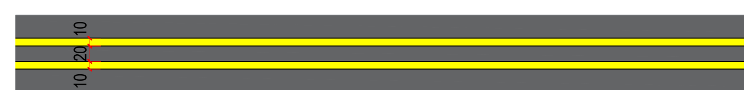
LFO-4 - LINHA CONTÍNUA / SECCIONADA ESCALA 1 : 50
