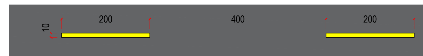
LFO-2 - LINHA SIMPLES SECCIONADA ESCALA 1 : 50
