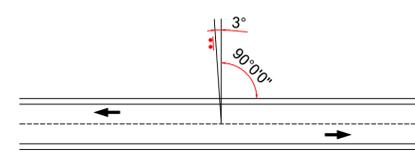
POSICIONAMENTO DOS SINAIS DE REGULAMENTAÇÃO - VIAS RURAIS SEM ACOSTAMENTO SEM ESCALA
