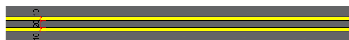
LFO-4 - LINHA CONTÍNUA / SECCIONADA ESCALA 1 : 50
