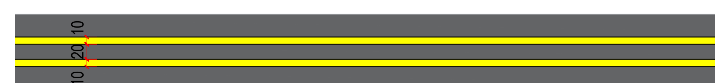
LFO-4 - LINHA CONTÍNUA / SECCIONADA ESCALA 1 : 50
