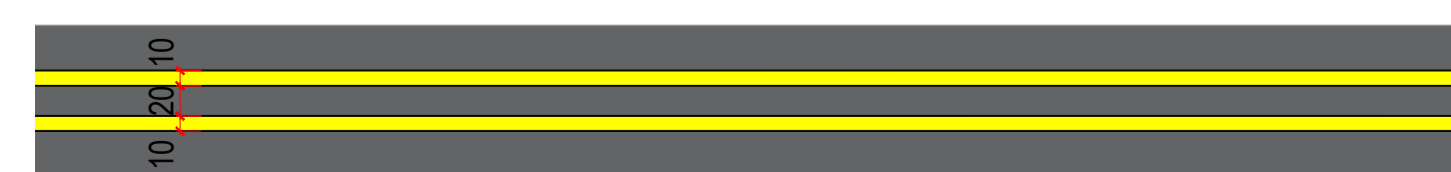
LFO-4 - LINHA CONTÍNUA / SECCIONADA ESCALA 1:50
